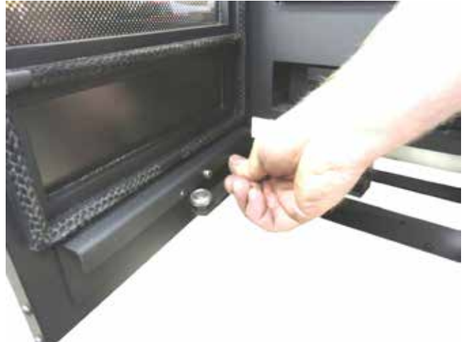
Fig.3 Bügel des Türschließers aushängen
