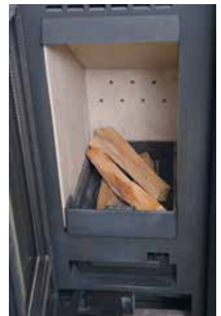
Auf den gesäuberten Rost bis zu vier Holzscheite kreuzweise aufstapeln. Unten größere, darauf kleiner Holzscheite.
