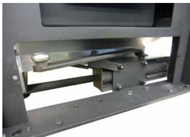
Fig.7 Türschließer rechts anschrauben
