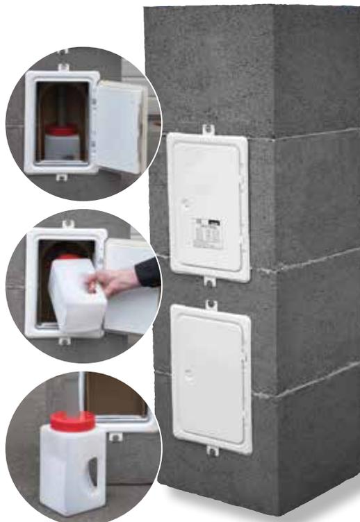
Fertigfuß „plus“ mit eingebautem Kondensatauffangbehälter, Flexschlauch, Ablaufbohrung im Boden und vorfixierter zweiter Revisionstür.
