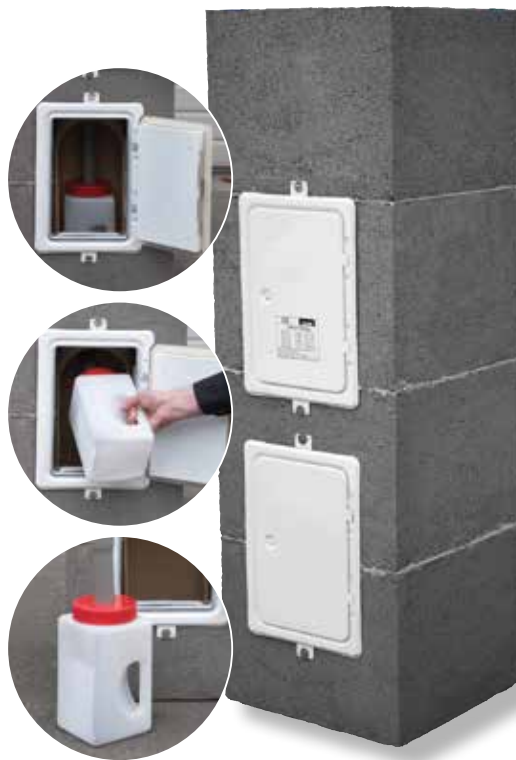
Fertigfuß „plus“ mit eingebautem Kondensatauffangbehälter, Flexschlauch, Ablaufbohrung im Boden und vorfixierter zweiter Revisionstür.
