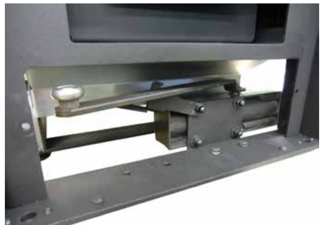
Fig.7 Türschließer rechts anschrauben
